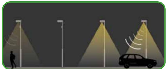
**Selektive Beleuchtungssteuerung:** Mittels Radarsensoren werden Bewegungen von Verkehrsteilnehmern erkannt. Funkknoten sorgen dafür das Licht vorauseilend hoch zu dimmen wenn es gebraucht wird und es danach wieder abzusenken. Dies reduziert den Stromverbrauch und die Lichtverschmutzung. Sobald der Sensor einer Leuchte Fußgänger oder Fahrzeuge detektiert, werden die nächsten Leuchten informiert, damit diese vorzeitig hochdimmen.
