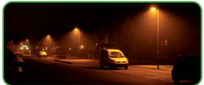
Ziel der neuen Masten und LED-Leuchtmittel ist es, die beleuchtete Fläche und nicht die Lichtquelle zu sehen. Damit wird auch Blendung vermieden und die Lichtverschmutzung (Abstrahlung nach oben und abseits der Verkehrsflächen) reduziert.
