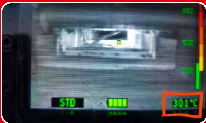
Zwischenraum Palette – Wärmebildkamera zeigt punktuell 301 Grad Celsius
